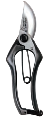
A-180-2 A型剪定鋏 7インチ 金止 全長:180mm/刃56mm/重量200g
